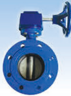
Корпус: чугун GGG-40, Диск: чугун GGG-40, Седло: EPDM Тип: двухфланцевый, фланцевое соединение по ГОСТ 12815-80 Давление: Ру10, Ру16 Размер: Ду50 - Ду1200
