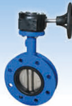
Корпус: чугун GGG-40, Диск: чугун GGG-40, Седло: EPDM Тип: двухфланцевый, фланцевое соединение по ГОСТ 12815-80 Давление: Ру10, Ру16 Размер: Ду50 - Ду1200
