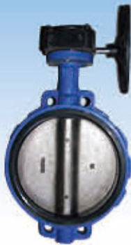
Корпус: чугун, Диск: чугун GGG-40 Седло: EPDM Тип: межфланцевый, фланцевое соединение по ГОСТ 12815-80 Давление: Ру10, Ру16 Размер: Ду250 - Ду600
